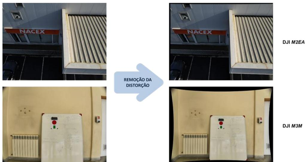
Figura 63 - Exemplos de remoção da distorção em imagens
