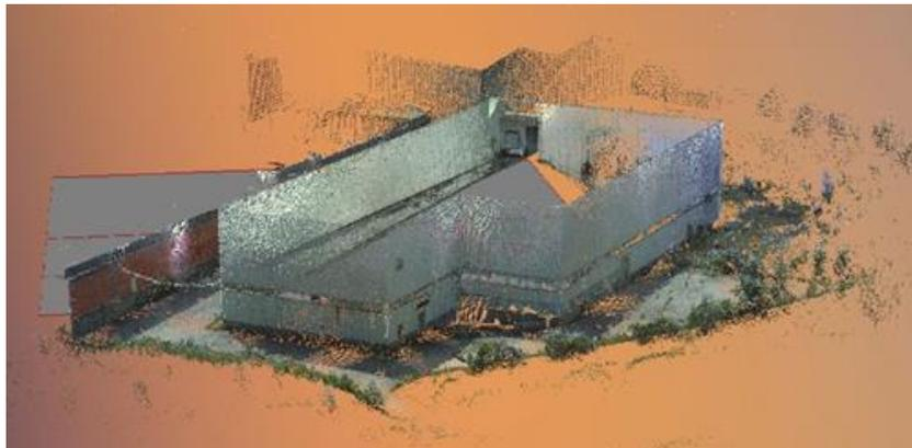
Figura 78 - Nuvem de pontos resultante do pré-processamento do levantamento efetuado com o *BLK360 G1*
