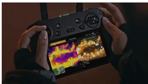
Figura 37 - Comando de controlo do DJI M3 (DJI, 2024)
