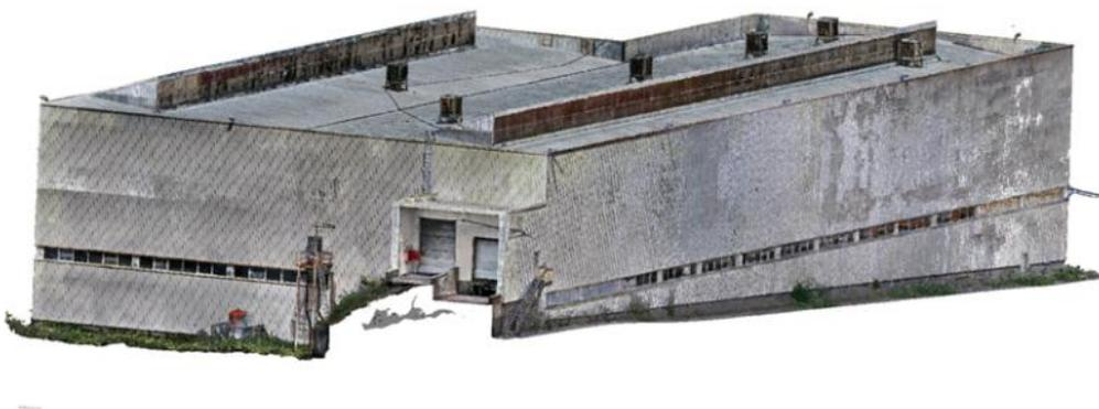
Figura 88 - Nuvem de pontos do caso de estudo final resultante da ICP
